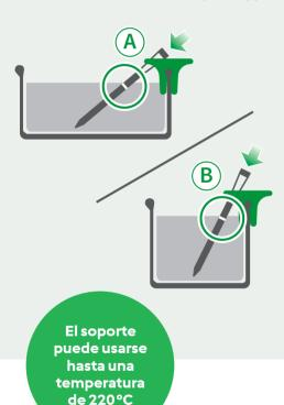
Coloca el soporte en el borde del molde como se muestra a continuación, desliza el termómetro a través del soporte e introdúcela en el alimento.
